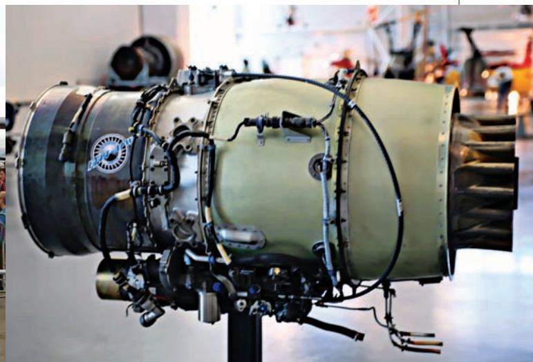
Турбовентилаторски мотор Williams FJ44
