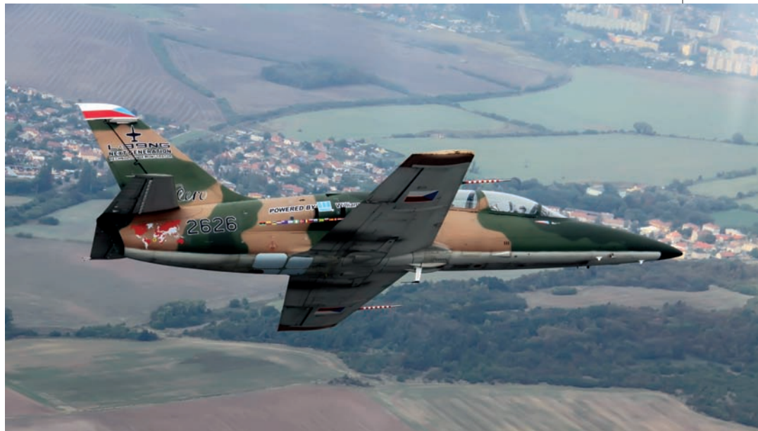
Први степен модернизације – L-39NG Stage 1 – без додатних резервоара на крајевима крила
